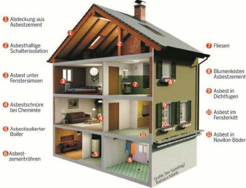
Asbestsanierung: Der krebserregende Werkstoff darf nur mit Schutzkleidern und Atemmaske entfernt werden. KEY
